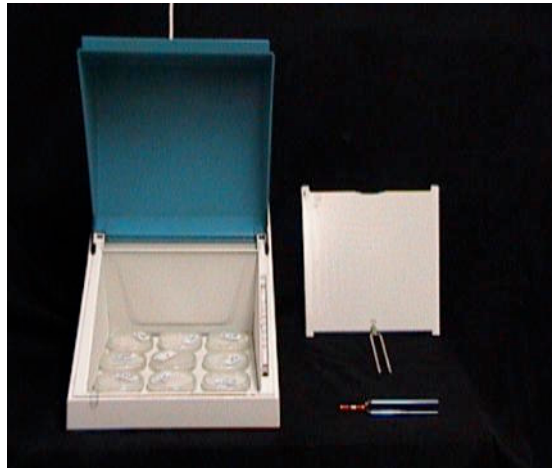
Abb. 2 Mikrobiologische Versuchsvorrichtung zur Untersuchung des Einflusses von mechanischen Wellen auf Pilzmycele. Auf dem Bild ist die „Vibe-Mushrooms“ Apparatur. Links im Bild - der Inkubator mit Mycelen, rechts – die Resonanzplatte (aus styrol acryl nitrol – SAN) mit Stimmgabeln.
