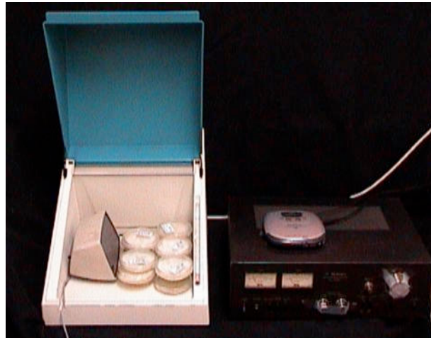
Abb. 4 Mikrobiologische Versuchsvorrichtung zur Untersuchung des Einflusses von mechanischen Wellen auf Pilzmycele. Auf dem Bild ist die „Sound-Mushrooms“ Apparatur. Links im Bild befindet sich der Inkubator mit Mycelen und einem Stereolautsprecher. Rechts ist die Stereoanlage (Verstärker mit dem CD-Player).
